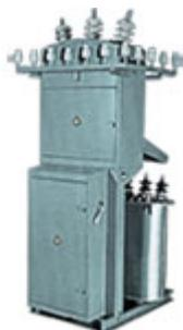
Комплектные трансформаторные подстанции наружной установки мачтового типа КТПм-25...250/6(10)/0,4 (далее КТП) предназначены для приема электрической энергии (переменного тока частотой 50 Гц) высокого напряжения (ВН) 6(10) кВ, преобразования ее в электрическую энергию низкого напряжения (НН) 0,4 кВ и распределения электрической энергии НН.
